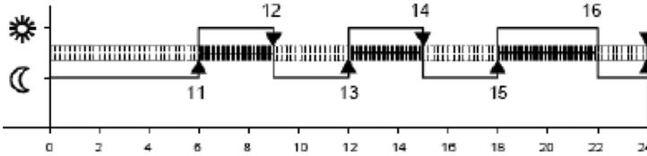
Ayarlanan saatler içinde kombi konfor modunda çalışarak normal ısınma sağlar; ayarlanmamış saatler dışında ise ekonomi moduna geçerek daha düşük seviyede ısınma sağlar. Bir gün için kombinin konfor modunda çalışması istenen 4 farklı zaman aralığı seçilebilir.
